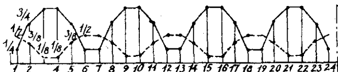
Hình 2-10. Bố trí dây quấn trong rãnh khi bố dây có số vòng dây khác nhau. 1- bối dây pha chính; 2- bối dây pha phụ.
