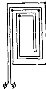
Hình 2-3. Bố dây quấn theo lối dây đôi.
